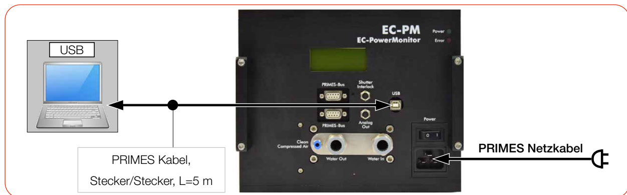
Abb. 7.5: Spannungsversorgung über das PRIMES Netzkabel, Datenübertragung über USB
