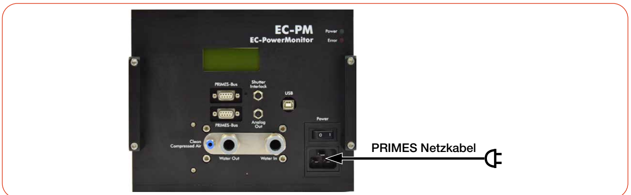
Abb. 7.3: Spannungsversorgung über das PRIMES Netzkabel, Anzeige der Messwerte am Gerät
